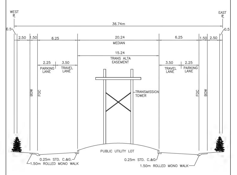
FIGURE 12 ENTRANCE COLLECTOR ROADWAY DETAIL
